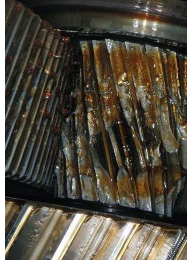
Afbeelding 6: versleten tandwielen geven vaak een 'zingend' geluid
